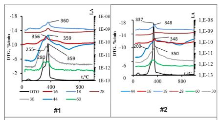
Fig.2. Releasing profiles of  $CH_4$  (M/z=16),  $H_2O$  (M/z=18), CO ((M/z=28), HCHO (M/z=30),  $CO_2$  (M/z=44) and  $CH_3COOH$  for aspen samples. Qr, mmol/g: 0(1), 1.4 (2).
